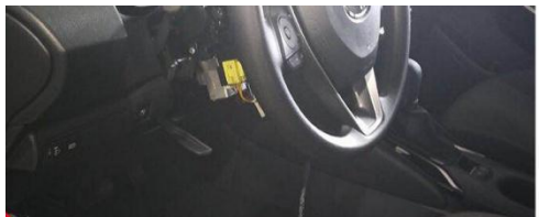
拆下方向盘盖板
